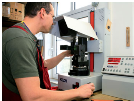
Exakt vermessen: Damit die Werkstücke richtig bearbeitet werden, misst die Maschine deren genaue Position.
