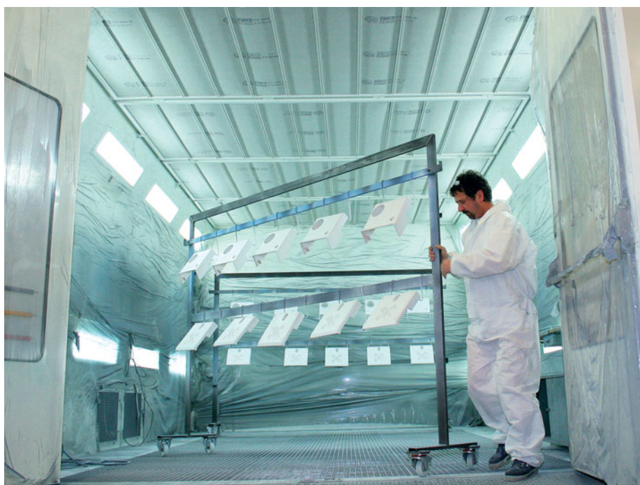
Wie gelackt: Die produzierten Gehäuse werden in der eigenen Lackierkammer verschönert. Dafür stehen sechs edle Farben zur Verfügung.
