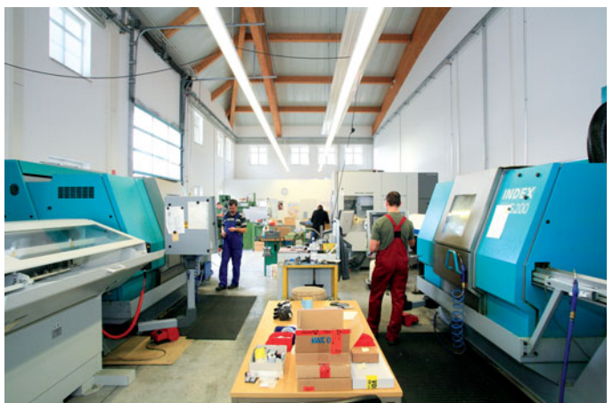
Modernste Technik: Die Hochleistungs-Dreh- und -Fräsaufmaschinen fertigen Teile für Motoren.
