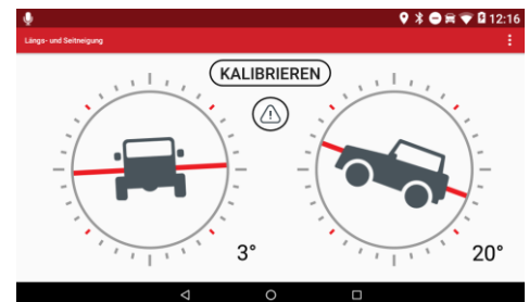
Integrierte Sensoren liefern Informationen sowie Warnhinweise zur Längs- und Seitenneigung des Fahrzeugs.
