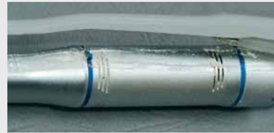
Die Kühlschlitze des Sprayhandstücks sind mit Schmutz gefüllt. Die Kühlung des Motors ist nicht mehr möglich. Ein Ausfall droht.
