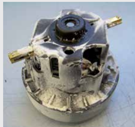
Verschmutzte Absaugturbine nach dem Platzen eines zu vollen Staubbeutels
