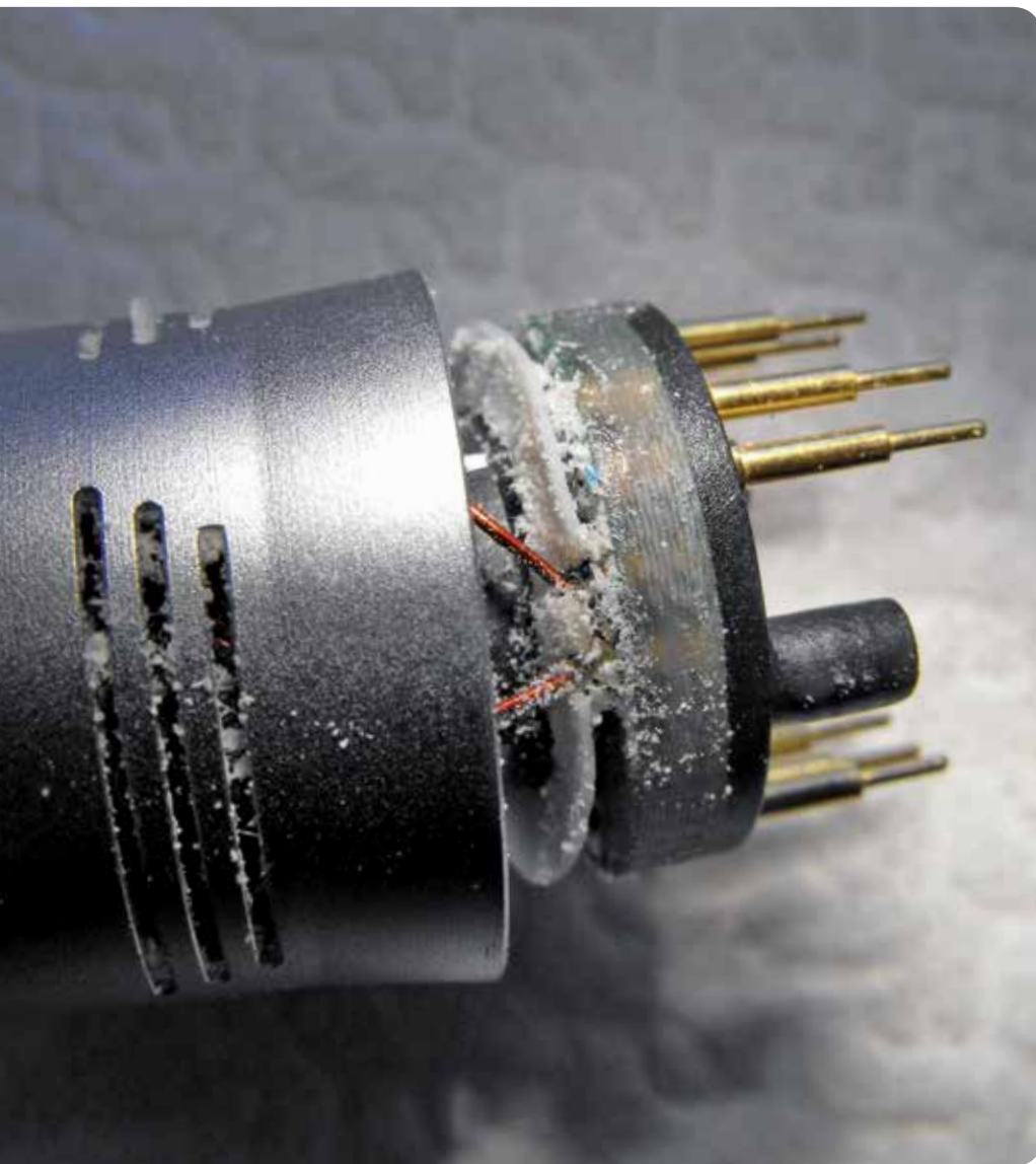
Ein geöffneter SIRIUS Handstückmotor, bei dem sich Rückstände am Anschlussstecker abgesetzt haben. Diese Rückstände entstehen vorwiegend unter Verwendung nicht zugelassener Spraylösungen. Mit der Zeit bilden sich Kurzschlüsse zwischen den goldene Kontakten und es kommt unweigerlich zum Ausfall des Handstückmotors.
