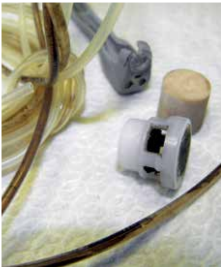
Ein verschmutzter Filter sowie verkeimte und veralgte Schläuche aus der Werkstatt.
