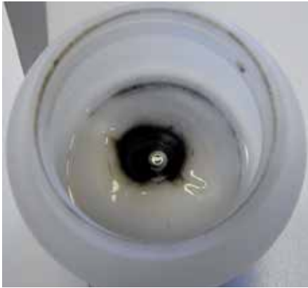
Ein Biofilm aus Algen und Keimen bildet sich im Tank von Spraygeräten, wenn unkonserviertes, destilliertes oder möglicherweise sogar Leitungswasser verwendet wird.
