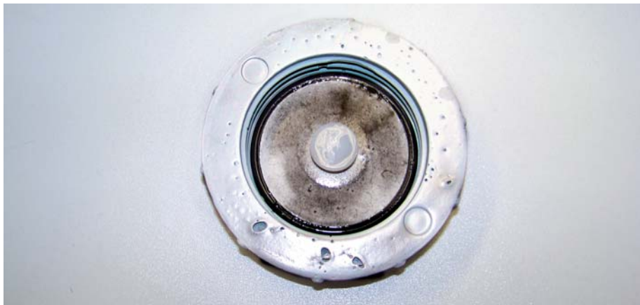
An der Innenseite des Tankdeckels hat sich ein Biofilm entwickelt, in dem Keime wachsen.
