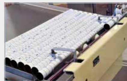
Die konifizierte Rohrabstufung der Aluminiumtuben lassen sich ineinanderstecken. Das spart Platz in der Lagerhaltung und macht die Tubenabfüllung wirtschaftlicher.
