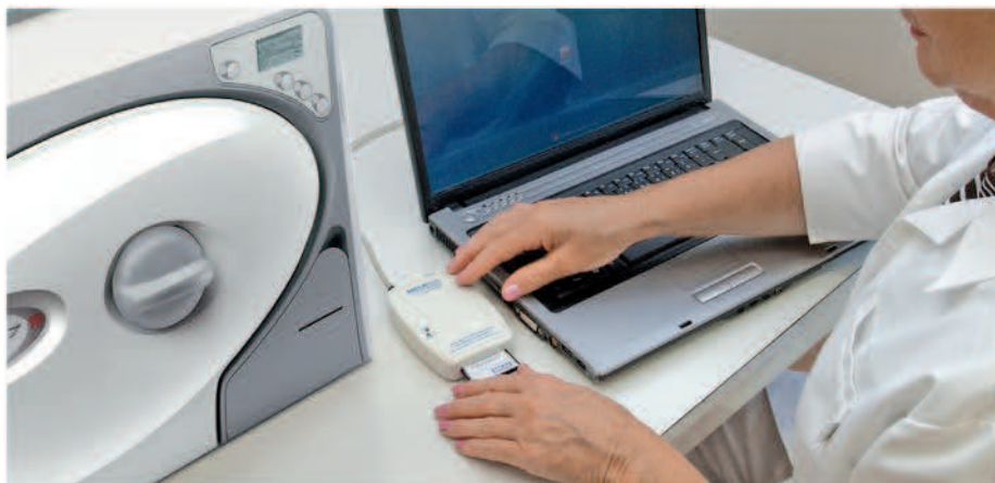
Moderne Euro-Norm-Autoklaven verfügen über eine verfahrenstechnische Validierung der wichtigsten Prozessparameter. Per SD-Karte können die Ergebnisse dokumentiert werden.
