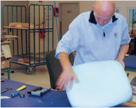
Die umschäumten Holzformelemente werden per Hand in der hauseigenen Polsterei mit dem stabilen Kunstleder bezogen.
