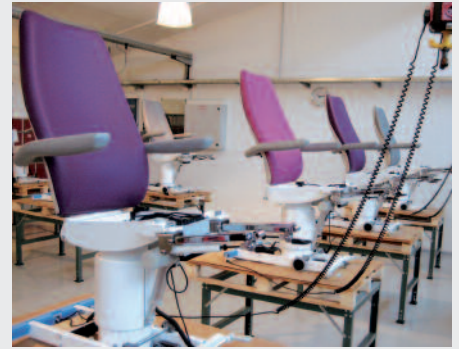
Bevor das Sitzpolster angebracht wird, werden die Antriebsmotoren über der Teleskop-hubsäule montiert.
