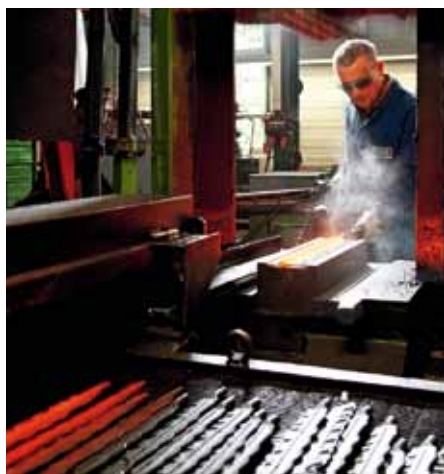
Blick in die Schmiede: Bei 1.000 °C werden die Rohteile geformt.
