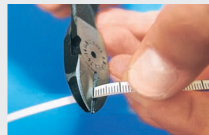
Abschneiden des ONYCLIP-Metallstreifens auf individuelle Länge mittels Drahtschneidezange.
